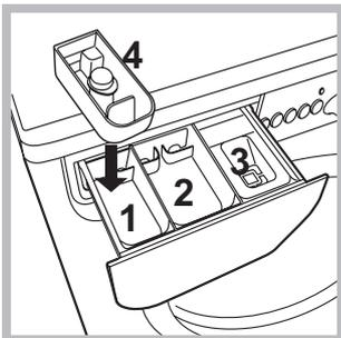
Выдвиньте распределитель и заполните его отделением моющим средством и смягчителем:
